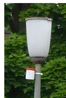
Abbildung 7: Passivsammlereinheit an Straßenlaterne
